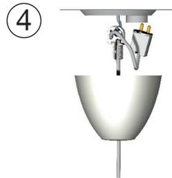
4 Hängen Sie die Schraube an den Deckenhaken und schließen Sie den Stecker an.
