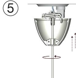
5 Bewegen Sie die Oberseite der Leuchte in Richtung der Schraube, die am Haken hängt. Wenn sich die Schraube und die „Mutter“ der Unterteile innerhalb der Abdeckung berühren, beginnen Sie die Abdeckung im Uhrzeigersinn festdrehen, bis sie die Decke erreicht.
