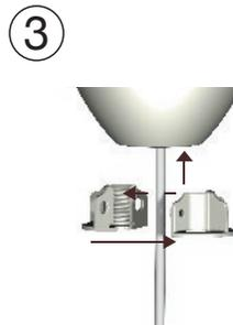
3 Setzen Sie die passenden Unterteile einander gegenüberliegend zusammen und schließen Sie dabei das Kabel zwischen Abdeckung und Leuchte ein. Setzen Sie das zusammengesetzte Unterteil in die Abdeckung ein, indem Sie die „Flügel“ in die Schlitz der Abdeckung stecken. Drücken Sie es an die Abdeckung, bis es richtig sitzt.
