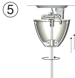
5 Bewegen Sie die Oberseite der Leuchte in Richtung der Schraube, die am Haken hängt. Wenn sich die Schraube und die „Mutter“ der Unterteile innerhalb der Abdeckung berühren, beginnen Sie die Abdeckung im Uhrzeigersinn festdrehen, bis sie die Decke erreicht.
