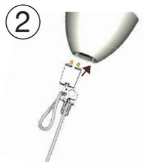
2 Setzen Sie Schraube, Stecker und restliches Kabel durch die Abdeckung von unten ein. Wenn der Ring verwendet werden soll, muss er bei der Durchführung mit einbezogen werden.
