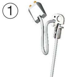
1 Sichern Sie das Kabel im oberen Teil der Schraube, beginnen Sie in der Mitte. Führen Sie es anschließend in die Öffnung entlang des Gewindes ein. Drücken Sie es nach unten in den Kanalboden.
