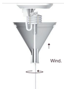
Ordnen Sie das überschüssige Kabel und die Schraube in der Deckendose so an, dass die Dose bündig mit der Decke abschließt. Wenn das Stromkabel von der Seite kommt, verwenden Sie den mitgelieferten Ring und drücken Sie eine der seitlichen Auslässe zur Seite, um Platz für das Kabel zu schaffen.
