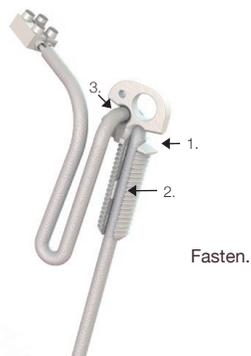
Befestigen Sie das Kabel in der gewünschten Hängehöhe an der Schraube. Beginnen Sie mit dem Loch an der Unterseite, drücken Sie das Kabel in den Kanal und führen Sie es abschließend durch das Loch an der Oberseite. Am Deckenhaken aufhängen und anschließen.
